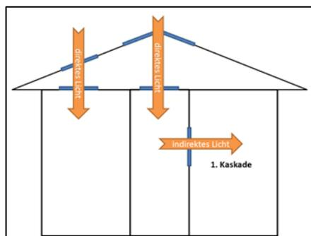
Wenn der direkte Lichteinfall von oben über eine Lichtplatte ermöglicht wird, kann das Licht für die darunterliegenden Räume als direkter Lichteinfall berücksichtigt werden. In diesem Fall ist auch die Weiterleitung als indirektes Licht über den Zentralgang möglich.
