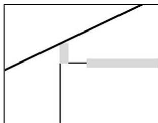
In diesem Beispiel kann das durch das Lichtband einfallende Licht als indirektes Licht für die in erster Kaskade angrenzenden Abteile angerechnet werden. Eine Weiterleitung über den Zentragang und dann in die Abteile ist nicht möglich.
